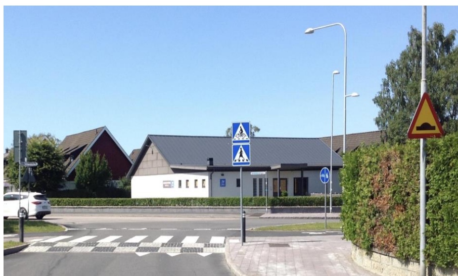
Billede fra Ångelholm i Sverige, bemærk hævet cykel- og gangfelt med både fodgænger- og cykelskilt.
